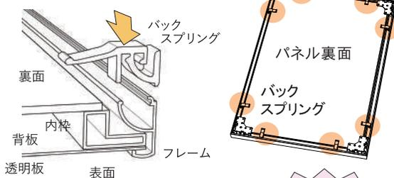
サイズにより付属数が異なります。全数をバランス良く配置してください。フレーム開閉時、spring OFF になった場合は、押し込んで ON に戻します。
