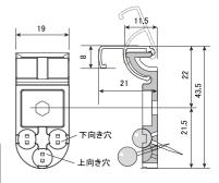
マップピン用穴は、斜めにガイドが ついています。上下の穴で向きを変えて 3本刺し込んでください。(上図は一例)
